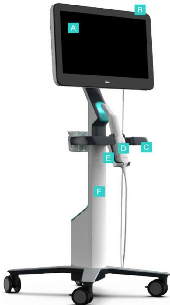
Obrázok 4: Pohľad spredu na iTero Element 2 Plus intraorálny skener konfigurácie vozíka
